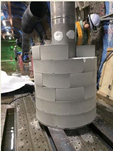
緩衝材再冠水試験供試体
