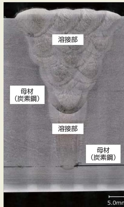
廃棄体容器試験体の溶接断面
