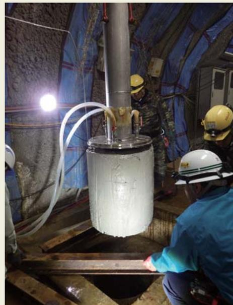
緩衝材再冠水試験後の供試体引き上げ
