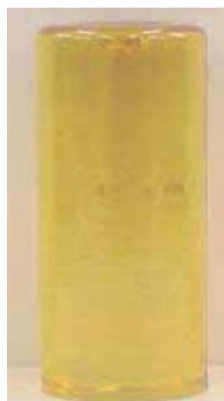
図 4-4 AgI ガラス固化体の外観
