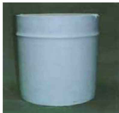
図 4-7 セメント固化体の外観 (20ℓ ペール缶内で固化して缶を除去したもの)
